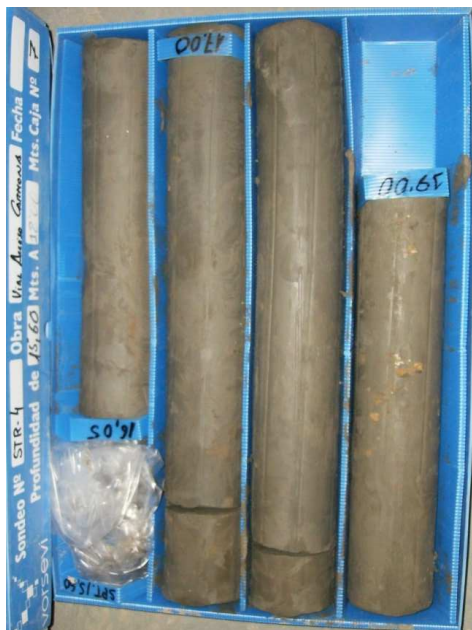
SONDEO STR-4: CAJA 7 DE 14 DE 15,60 A 19,00 m.
