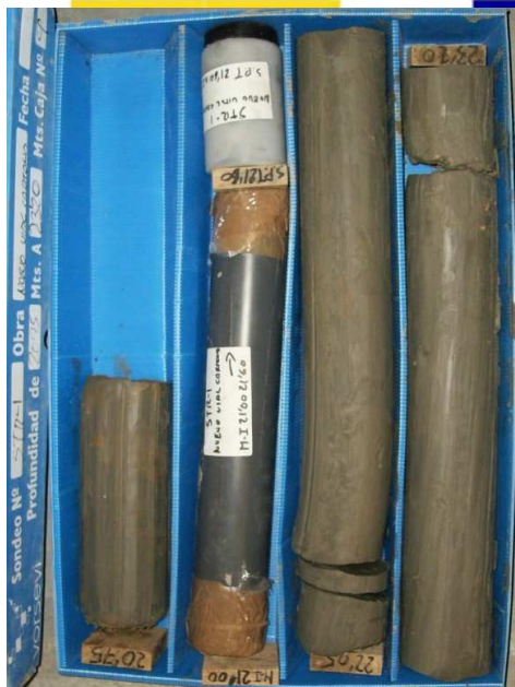
SONDEO STR-1: CAJA 9 DE 14 DE 20,75 A 23,20 m.
