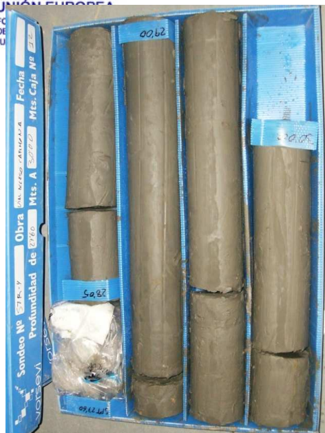
SONDEO STR-4: CAJA 9 DE 14 DE 20,60 A 23,00 m.
