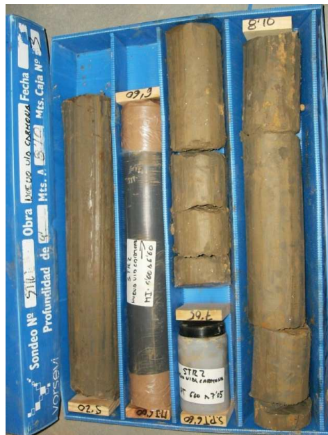
SONDEO STR-2: CAJA 3 DE 15 DE 5,20 A 8,10 m.
