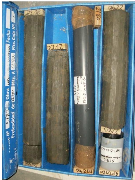
SONDEO STR-2: CAJA 6 DE 15 DE 12,60 A 15,00 m.
