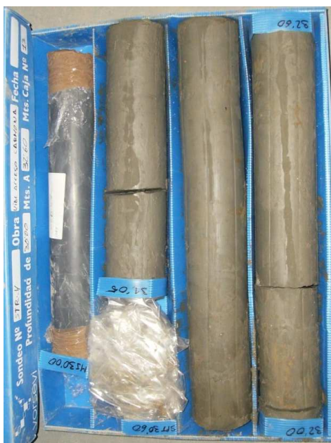
SONDEO STR-4: CAJA 13 DE 14 DE 30,00 A 32,60 m.
