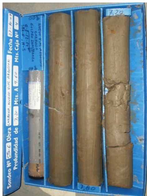
SONDEO STR-6: CAJA 4 DE 15 DE 7,20 A 9,60 m.
