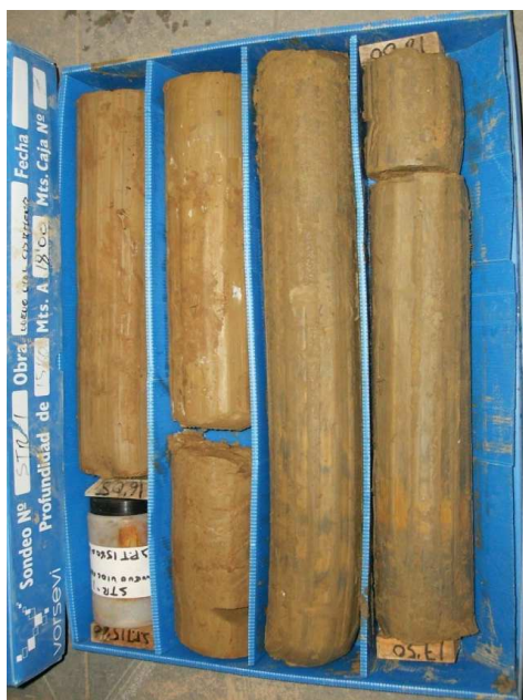
SONDEO STR-1: CAJA 7 DE 14 DE 15,60 A 18,00 m.
