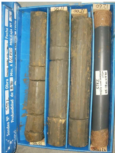
SONDEO STR-2: CAJA 5 DE 15 DE 10,40 A 12,60 m.
