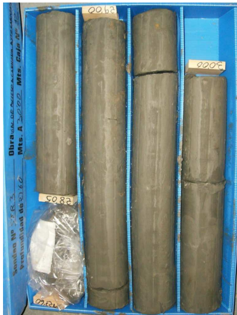
SONDEO STR-3: CAJA 12 DE 14 DE 27,60 A 30,00 m.
