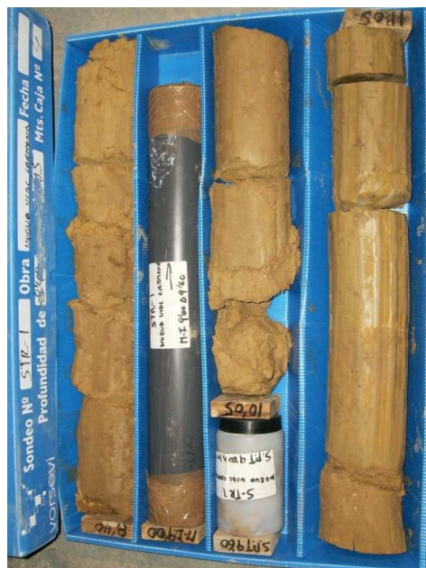
SONDEO STR-1: CAJA 4 DE 14 DE 8,40 A 11,05 m.
