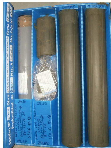
SONDEO STR-6: CAJA 8 DE 15 DE 16,80 A 19,40 m.
