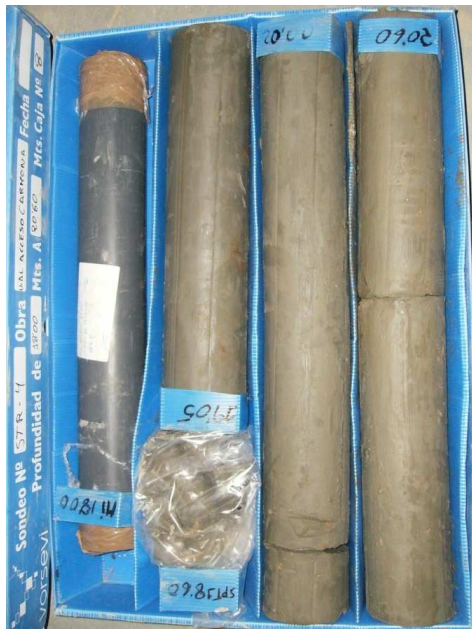
SONDEO STR-4: CAJA 8 DE 14 DE 18,00 A 20,60 m.
