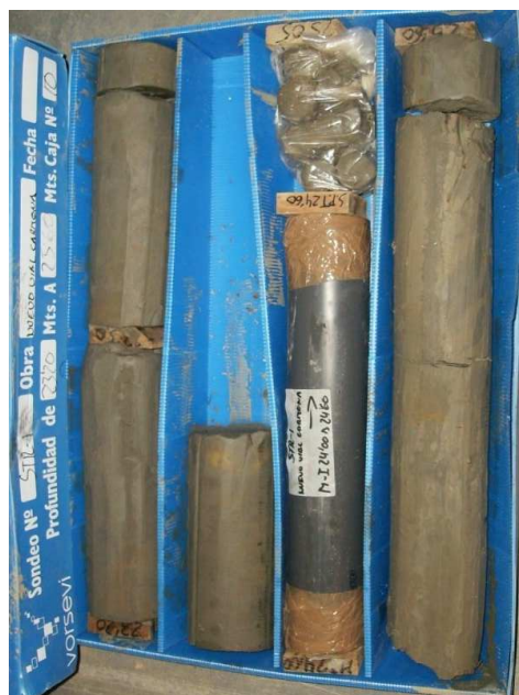
SONDEO STR-1: CAJA 7 DE 14 DE 15,60 A 18,00 m.
