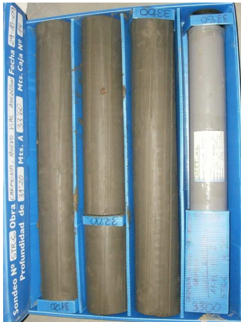
SONDEO STR-6: CAJA 14 DE 15 DE 31,20 A 33,60 m.
