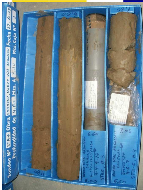
SONDEO STR-6: CAJA 3 DE 15 DE 4,80 A 7,20 m.
