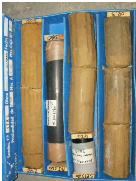
SONDEO STR-2: CAJA 2 DE 15 DE 2,40 A 5,20 m.
