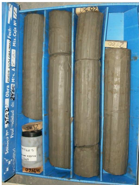
SONDEO STR-2: CAJA 11 DE 15 DE 24,60 A 27,00 m.
