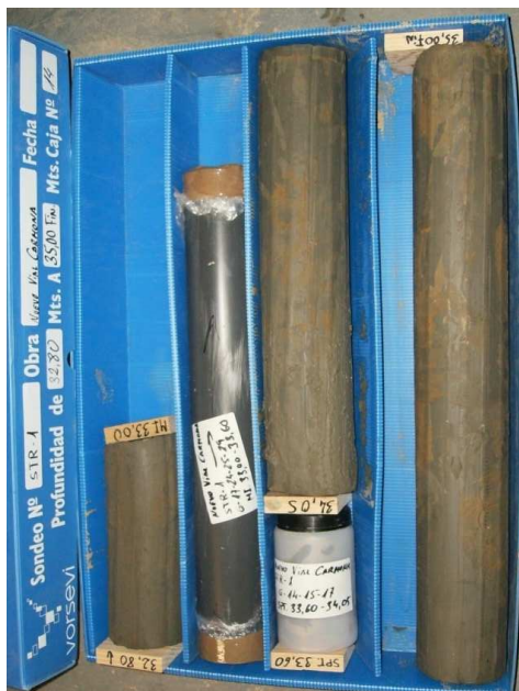
SONDEO STR-1: CAJA 14 DE 14 DE 32,80 A 35,00 m.
