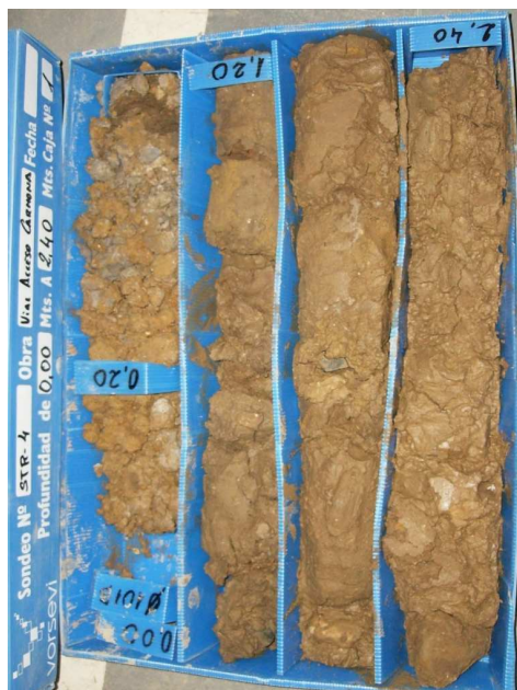
SONDEO STR-4: CAJA 1 DE 14 DE 0,00 A 2,40 m.
