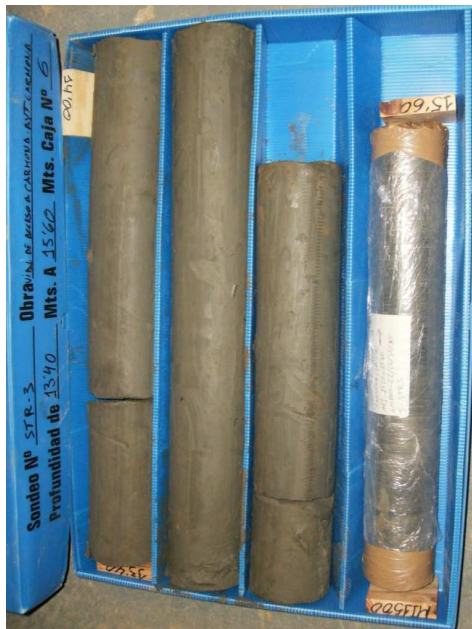
SONDEO STR-3: CAJA 6 DE 14 DE 13,40 A 15,60 m.
