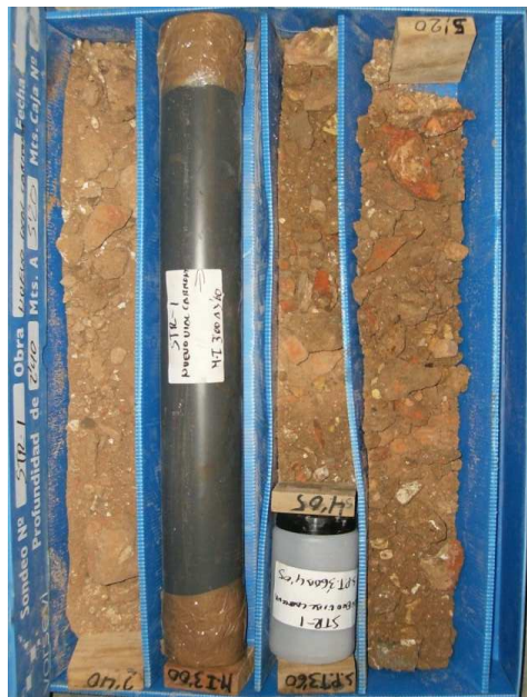
SONDEO STR-1: CAJA 2 DE 14 DE 2,40 A 5,20 m.
