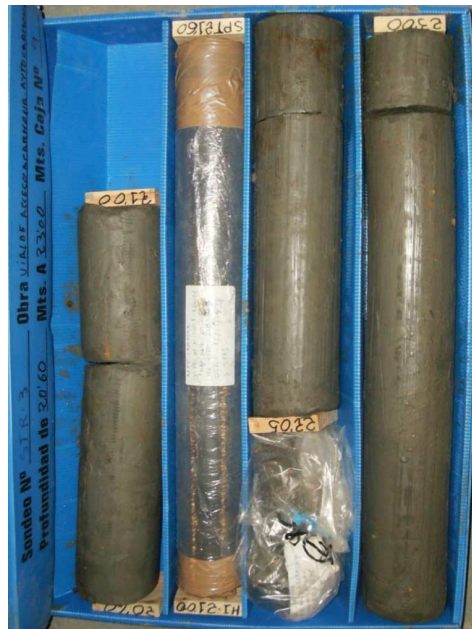
SONDEO STR-3: CAJA 6 DE 14 DE 13,40 A 15,60 m.
