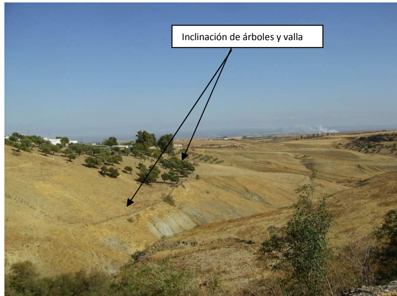
Foto 11.1. Se observan signos de reptación que se ponen de manifiesto en la inclinación de los árboles y la valla.
