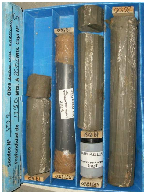
SONDEO STR-2: CAJA 5 DE 15 DE 10,40 A 12,60 m.
