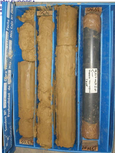
SONDEO STR-1: CAJA 6 DE 14 DE 13,05 A 15,60 m.
