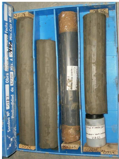
SONDEO STR-2: CAJA 11 DE 15 DE 24,60 A 27,00 m.
