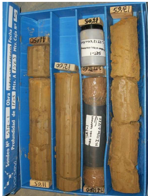
SONDEO STR-1: CAJA 5 DE 14 DE 11,05 A 13,05 m.
