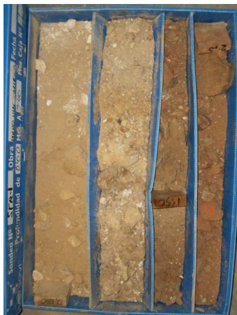
SONDEO STR-1: CAJA 1 DE 14 DE 0,00 A 2,40 m.
