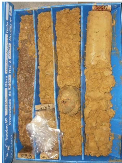
SONDEO STR-5: CAJA 4 DE 14 DE 8,60 A 11,20 m.
