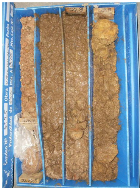
SONDEO STR-5: CAJA 3 DE 14 DE 6,00 A 8,60 m.
