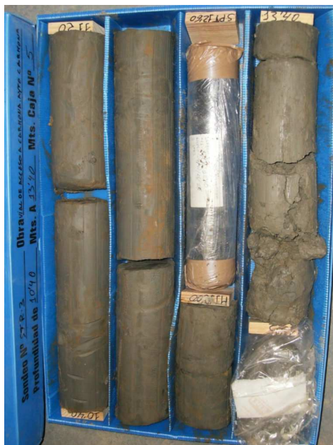
SONDEO STR-3: CAJA 5 DE 14 DE 10,40 A 13,40 m.
