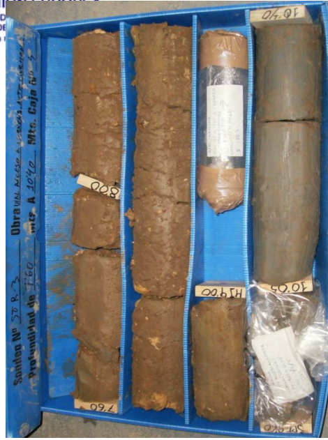
SONDEO STR-3: CAJA 4 DE 14 DE 7,60 A 10,40 m.
