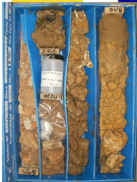
SONDEO STR-1: CAJA 3 DE 14 DE 5,20 A 8,40 m.
