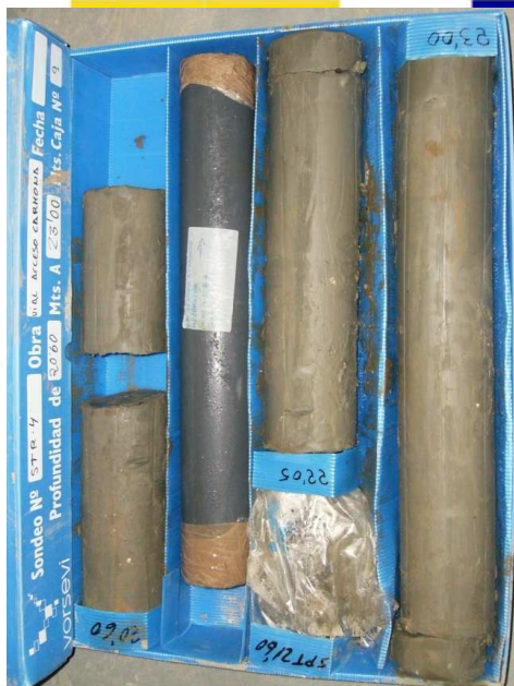
SONDEO STR-4: CAJA 9 DE 14 DE 20,60 A 23,00 m.
