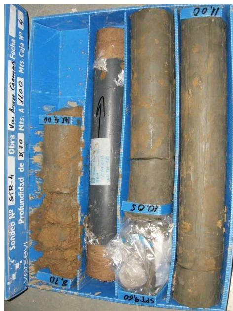
SONDEO STR-4: CAJA 4 DE 14 DE 8,70 A 11,00 m.
