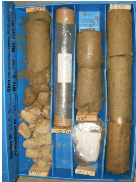
SONDEO STR-3: CAJA 2 DE 14 DE 2,40 A 5,00 m.
