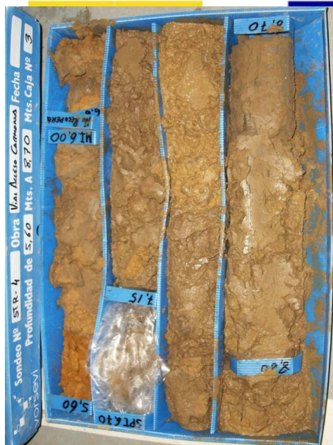
SONDEO STR-4: CAJA 3 DE 14 DE 5,60 A 8,70 m.
