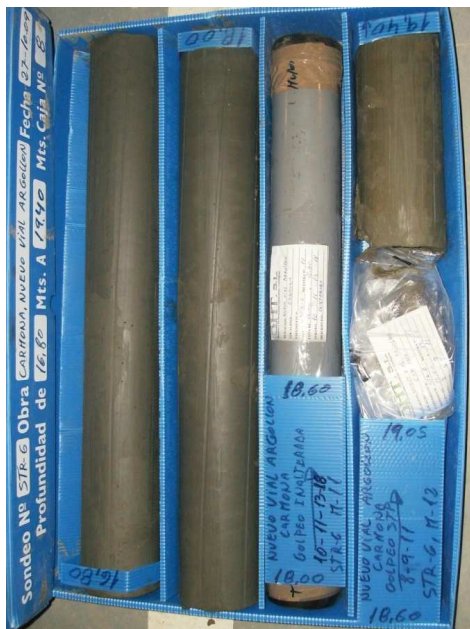
SONDEO STR-6: CAJA 8 DE 15 DE 16,80 A 19,40 m.
