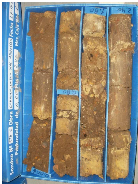
SONDEO STR-6: CAJA 1 DE 15 DE 0,00 A 2,40 m.
